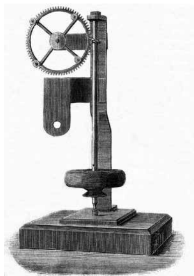
Аппарат «для анализа стробоскопических явлений»
